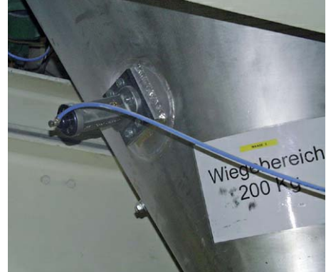
Décolmatage de réservoirs de pesage
